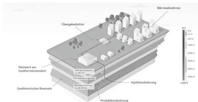
Schematische Funktionsweise einer Geothermieanlage
